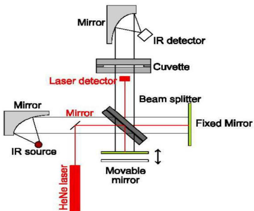
Figure 20 : Schéma de fonctionnement d'un spectromètre FTIR.
