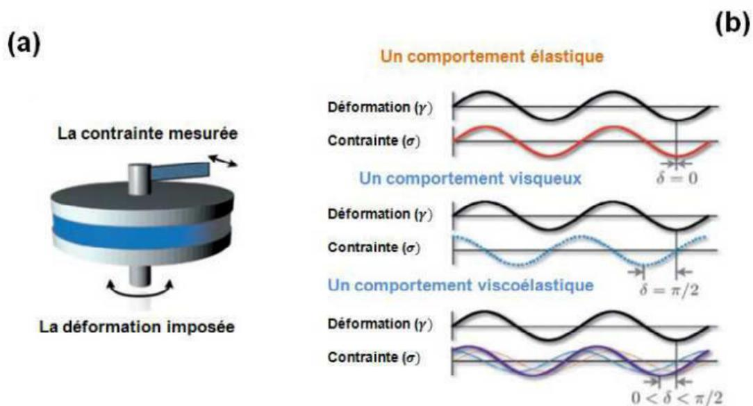
**Figure 19 :** (a) Schéma d'un échantillon placé entre deux plaques d'un rhéomètre, (b) Exemple de réponse en contrainte à la déformation de cisaillement appliquée à un solide élastique, un liquide visqueux et un matériau viscoélastique (Meziani, 2012).
